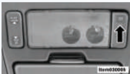
کلید چراغ‌های داخل اتاق
