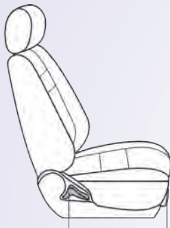
اهرم تنظیم به جلو و عقب صندلی دستگیره تنظیم پشتی صندلی
