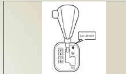
برای حرکت دادن دسته دندۀ از حالت "P" به "R" یا از "N" به "R" و یا از "R" به "P" باید دکمه ضامن بر روی دسته دندۀ فشار داده شود. در سایر حالت‌ها نیازی به فشار دادن این دکمه نیست.
