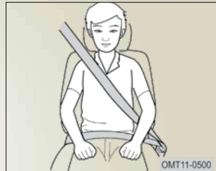
کمربند ایمنی باید به طور منظم با بت خرابی و فرسودگی مورد بازدید قرار گیرد. در صورت بروز تصادف و عمل کردن پیش‌کشنده کمربند، می‌بایست بلافضله کمربند و قطعات مربوطه توسط نمایندگی مجاز مدیران خودرو تعویض شوند.
